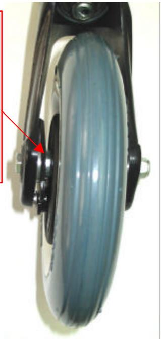
固定金具の方向に注意してフォークへ取付けてください。
